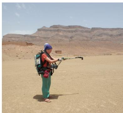
Figure 16. Prise de mesures spectrales in situ sur végétation herbacée et sol
